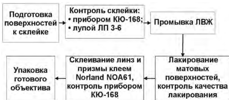
Рис. 5.22. Технологический процесс склеивания линз с призмой
